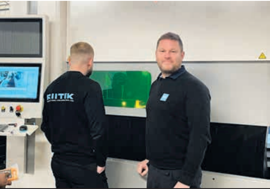
Topi Palsa (oik.) esittelemässä uutta 6 kilowatin putkilaseria, jossa on moninaiset leikkaukset mahdollistava 3D-leikkauspää.
