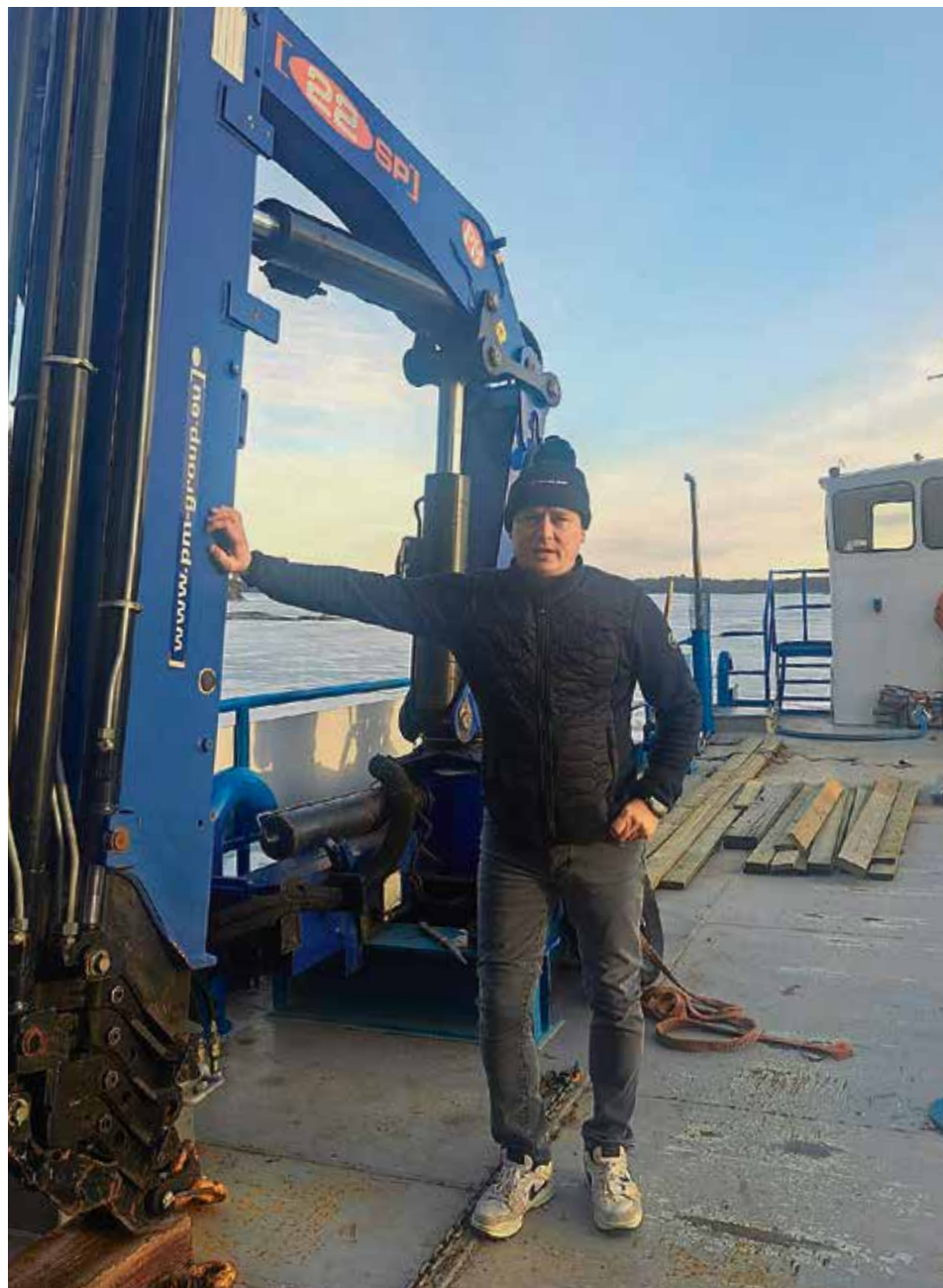
Aluksen nosturilla voi nostaa lautan kannelta 16 metrin päähän tonnin painoisen lastin, kuten hirsi- tai lautanipun. Nosturin vieressä Jani Puurtinen.
