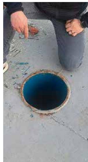
Apukka aluksen erikoisuutena on keskellä sedimentti porausreikä, jonka avulla voi kannen läpi turvallisesti tutkia järven pohjaa, tehdä koeporauksia ja ottaa näytteitä.
